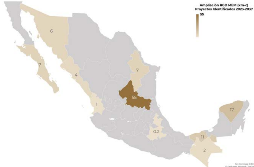
FIGURA 5.26 LONGITUD (km-c) DE LAS LÍNEAS DE TRANSMISIÓN DE AMPLIACIÓN DE LA RNT IDENTIFICADAS POR ENTIDAD FEDERATIVA, ASOCIADAS A PROYECTOS DE AMPLIACIÓN DE LA RGD DEL MEM
